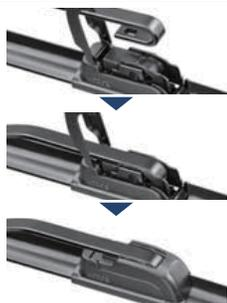
スマートなフォルムを損なわないコンパクトサイズのアダプターを採用。アームのU字部分を覆うカバーと、フック部分の両サイドから挟みこむ二重ロックの安心設計。簡単で確実な取り付けが可能です。
