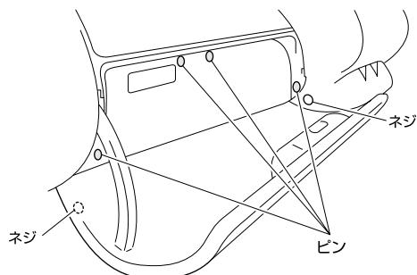
グローブボックスを開き、ネジ（2箇所）、ピン（4箇所）を外し、グローブボックスを手前に引いて取り外してください。
