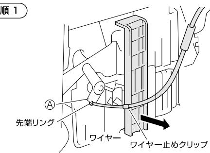
ワイヤーを止めてあるクリップから外し、先端リングを④部から外してください。
