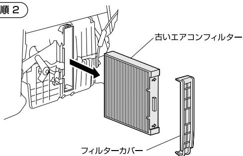
フィルターカバー（再使用します）を取り外し、古いエアコンフィルターを取り出してください。
