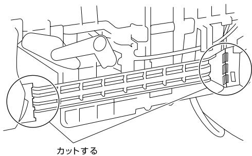
樹脂製カバーが装着されている場合は、図のように両サイドのグローブボックスフレーム部を切り取ってください。
