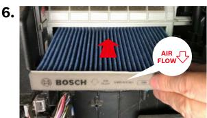
フィルターの向きと「AIR FLOW↓」マークが図のようになっていることを確認し、新しいボッシュ エアコンフィルターを取り付けます。
