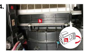
フィルターカバー<mark>D</mark>右端のツメを矢印の方向へ持ち上げて フィルターカバー<mark>D</mark>を取り外します。
