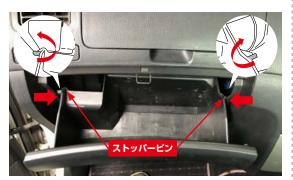
❷グローブボックス ②の側面を矢印の方向に押してストッパーピン(左右2ヵ所)を内側に押し込んでグローブボックスを取り付けます。
