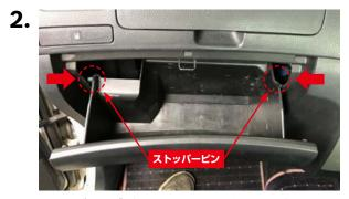
開いたグローブボックス 1の側面を矢印の方向に押してストッパーピン (左右2ヵ所)を内側に押し込んでグローブボックスを下ろします。
