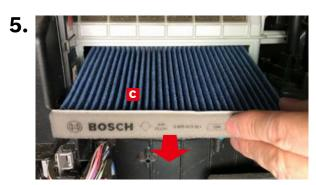
古いエアコンフィルターでを矢印の方向へ取り外します。
