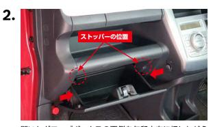
開いたグローブボックスの両側を矢印方向に押しながら 奥のストッパー(左右2箇所)を解除してグローブボックス aを手前に引き出して外します。
