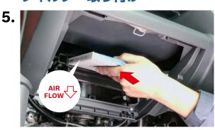
フィルターの向きと「AIR FLOW↓」マークが図のようになっていることを確認し、新しいボッシュ エアコンフィルターを矢印の方向から挿入して取り付けます。
