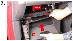
グローブボックス 2のフック (左右2箇所)の位置を合わせて矢印方向に押し込みます。グローブボックス両側のストッパー (左右2箇所)を押し込むようにグローブボックス 2を閉じます。
