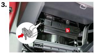
フィルターカバー・のツメを矢印の方向に押してフィルターカバー・を取り外します。
