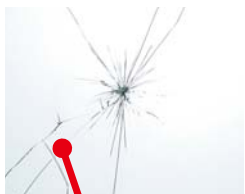
フロントウインドウの損傷
