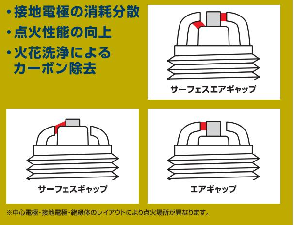
※中心電極・接地電極・絶縁体のレイアウトにより点火場所が異なります。
