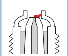
絶縁体の表面を伝わり接地電極と中心電極の間で放電。
