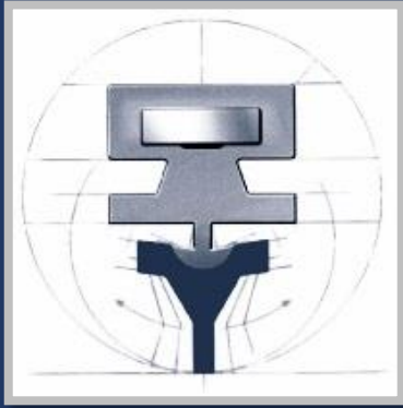
ボッシュ・ツインゴム登場 - ガラスとの接地面用には硬めのゴム、ベース用に柔軟性ゴムを採用
