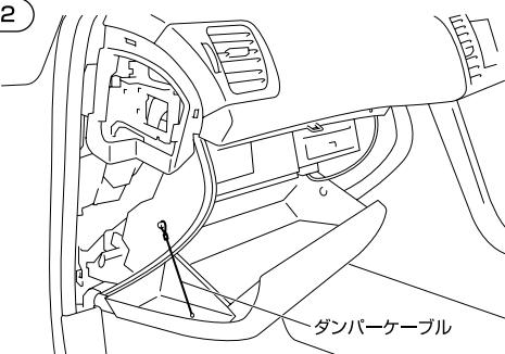
横パネルの中にあるダンバーケーブルを外してください。
