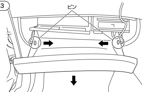
グローブボックス両側を内側へ曲げながらピンの引っかかりを通過させ、取り外してください。
