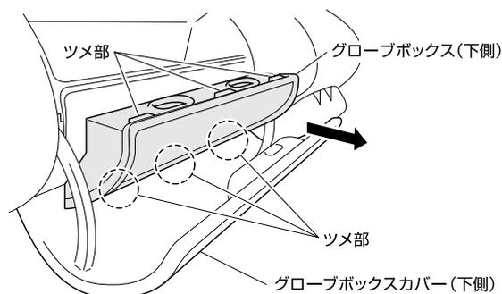
下側のグローブボックスカバーを開き、グローブボックスのツメ（6箇所）を外して矢印の方向に取り出してください。
