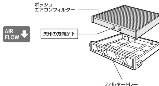
ボッシュエアコンフィルターのステッカー貼り付け面を手前にし矢印が下を向くよう取り付けてください。フィルタートレー溝部にフィルターのヒダを挟み込んで取り付けてください。
