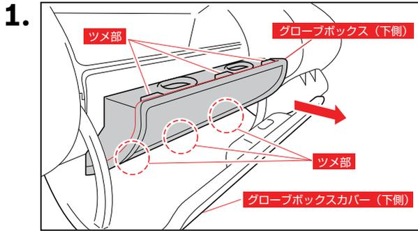
下側のグローブボックスカバーを開き、グローブボックスのツメ（6箇所）をはずして矢印の方向に取りはずしてください。
