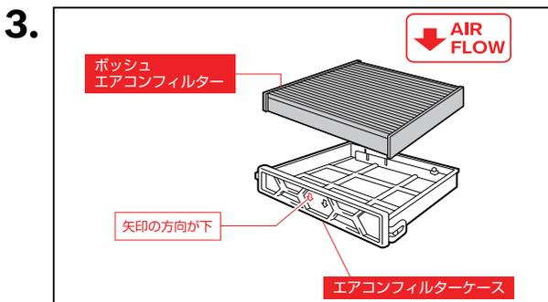
車両側の古いフィルターを取りはずし、ポッシュ エアコンフィルターを「AIR FLOWの矢印」が下を向くようフィルターケースに組み付けてください。
