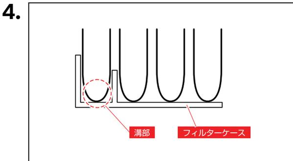
ポッシュ エアコンフィルターの矢印を下向きにし、フィルターケース溝部にフィルターのヒダを挟み込んで取付けてください。
