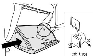
グローブボックスを開き、内側右側面のクリップ(1箇所)を番号順にスライドさせて外してください。左側のストッパーを外し、グローブボックスを取り外してください。
