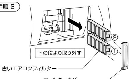
エアコンフィルターカバーを取り外し、車両側の古いフィルターを下の段→上の段の順に手前に引き出してください。
