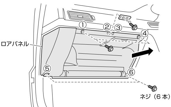
ネジ（6箇所）を外し、ロアパネルを手前に引いて取り外してください。
