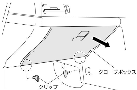
グローブボックス下側のクリップ（2箇所）を抜いて、グローブボックスを取り外してください。
