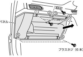
ネジ(6箇所)を外し、パネルを手前に引いて取り外してください。パネルを外した後、ハーネス本体を持ってパネルから外してください。
