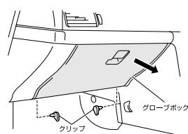
グローブボックス下側のクリップ(2箇所)を抜いて、グローブボックスを取り外してください。
