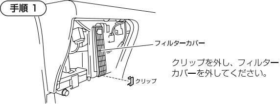
クリップを外し、フィルターカバーを外してください。
