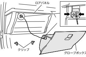
グローブボックス下側のクリップ(2箇所)を抜いて、グローブボックスを取り外し、ダンパーを矢印方向につまんで引っ張ってください。
