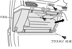
ネジ(6箇所)を外し、パネルを手前に引いて取り外してください。パネルを外した後、ハーネス本体を持ってパネルから外してください。
