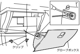
グローブボックス下側のクリップ(2箇所)を抜いて、グローブボックスを取り外しダンパーをマイナスドライバー等を使用し取り外してください。
