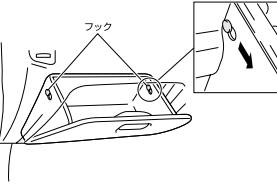
矢印の方向にフック(2箇所)を動かして、グローブボックスを取り外してください。
