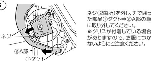
ネジ(2箇所)を外し、丸で囲った部品①ダクト⇒②A部の順に取り外してください。
