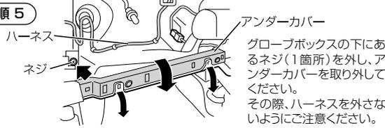
グローブボックスの下にあるネジ(1箇所)を外し、アンダーカバーを取り外してください。その際、ハーネスを外さないようにご注意ください。
