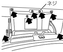
グローブボックスを開き、内側にあるネジ(7箇所)をドライバーなどで取り外してください。
