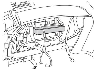
フィルターカバーを取り外し、古いエアコンフィルターを引き出して取り出してください。
