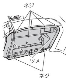
ネジ (7箇所)、ツメ (2ヶ所) を外し、カバーを取り外してください。
