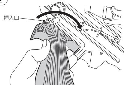
フィルターを挿入の際は図のように回し込むように挿入すると、作業しやすくなります。
