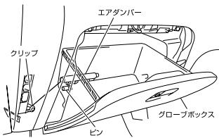
グローブボックスを開き、エアーダンパーの固定クリップ(1箇所)を外してください。グローブボックス内のピン(2箇所)を外し、グローブボックスを取り外してください。
