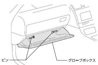
グローブボックスを開き、下側のピン(2箇所)を外し、グローブボックスを取り外してください。
