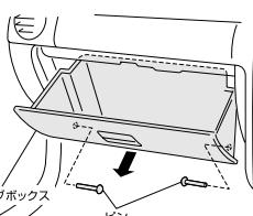
グローブボックスを開き、ピン(2箇所)を外し、グローブボックスを取り外してください。
