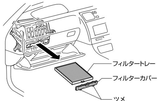
フィルターカバーをツメをつまんで取り外し、車両側のエアコンフィルタートレーを手前に引き出してください。
