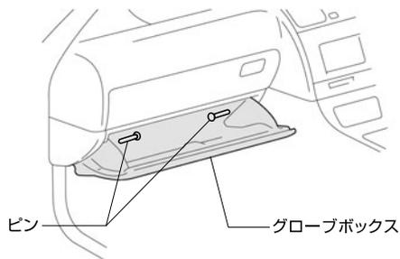
内側のピン (2箇所) を外し、グローブボックスを取り外してください。
