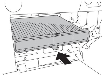
ボッシュ エアコンフィルターを「AIR FLOWの矢印」が下を向くよう挿入してください。取りはずした車両側部品を復元し、交換ステッカーをグローブボックス内側に貼り付けてください。
