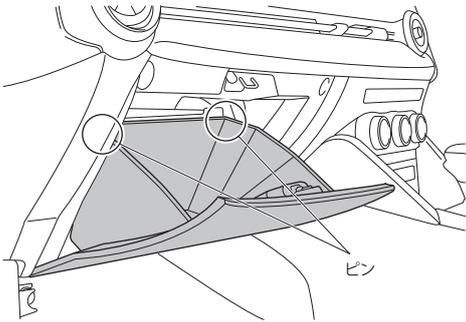
グローブボックスを開き、両側から押さえてピン(2箇所)をはずし、グローブボックスを取りはずしてください。
