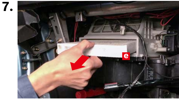
古いエアコンフィルター e を取り外します。
