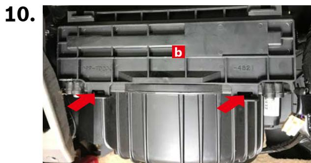
フィルターカバー**b**の2箇所のツメを矢印の方向へ押し付けて取り付けます。
