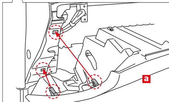
グローブボックス**a**左側2ヵ所のガイドピンを車両側の受け口に合わせながら、矢印の方向へグローブボックスを押し付けて取り付けます。
