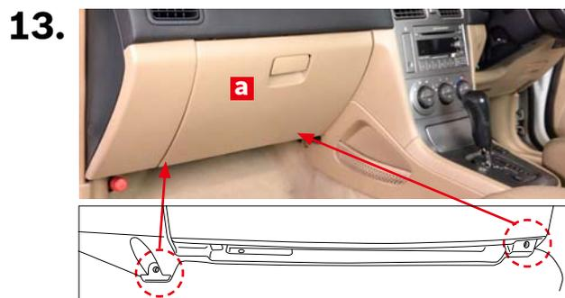
プラスドライバーを使用してグローブボックス**a**下部のスクリュー（金属製2本）を取り付けます。
