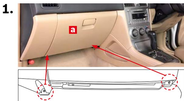
プラスドライバーを使用してグローブボックスa下部のスクリュー（金属製2本）を取り外します。
