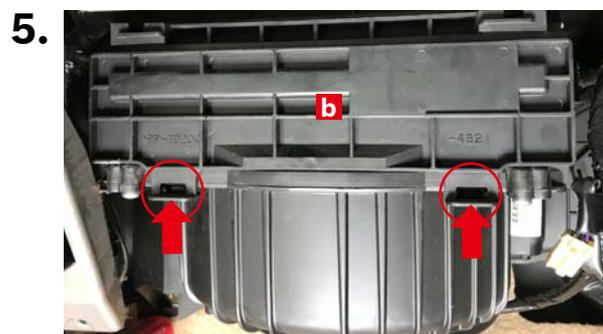
フィルターカバーbの2カ所のツメを矢印の方向へ押して、カバー下部のロックを解除します。
