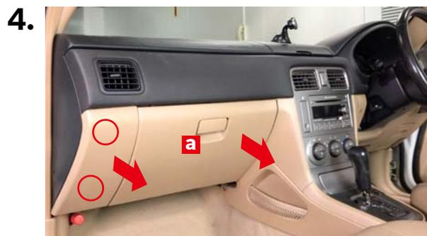
グローブボックスaを矢印の方向へ引き出します。赤枠箇所2カ所にクリップがありますので、少し強めに引いて取り外します。
