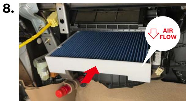
フィルターの向きと「AIR FLOW」マークが図のようになっていることを確認し、新しいポッシュ エアコンフィルターを矢印の方向から挿入して取り付けます。
