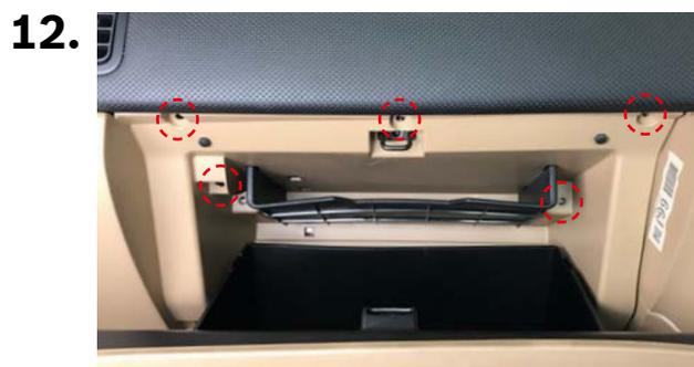
プラスドライバーを使用してグローブボックス奥のスクリュー（金属製5本）を取り付けます。
