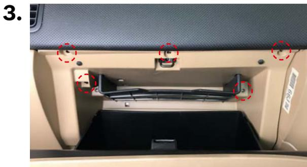
プラスドライバーを使用してグローブボックス奥のスクリュー（金属製5本）を外します。
