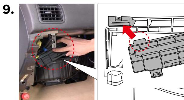
車両側の金属ステーをかわすように、フィルターカバーを傾けながら突起部分を挿入します。
