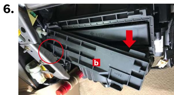
フィルターカバーbを矢印の方向へ傾けて車両側の金属ステーをかわすようにして取り外します。
