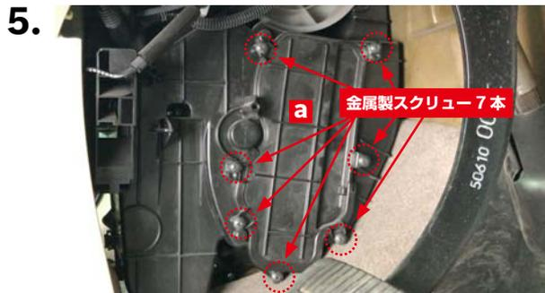
フィルターカバー**a**の取り付けスクルー（金属製7本）を+ドライバーで締め付けます。
