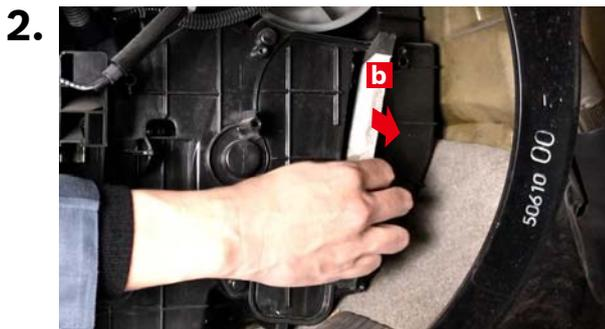
古いエアコンフィルター**b**を矢印の方向へスライドさせて取り外します。
