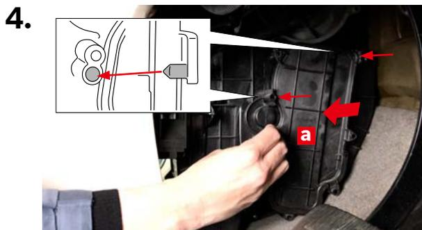
フィルターカバー**a**の突起部分（2ヵ所）を車両側の受け穴に合わせてフィルターカバー**a**を取り付けます。
