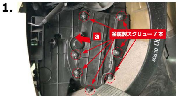
運転席足元左奥のフィルターカバー**a**の取り付けスクルー（金属製7本）を+ドライバーで取り外し、フィルターカバー**a**を矢印方向に外します。
