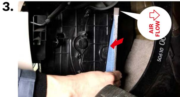
フィルターの向きと「AIR FLOW」マークが図のようになっていることを確認し、新しいボッシュ エアコンフィルターを矢印の方向から挿入して取り付けます。
