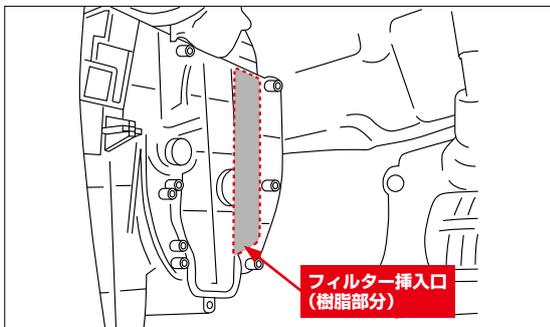
フィルター挿入口を、図のように点線に沿ってカッターなどで切り取ってください。
