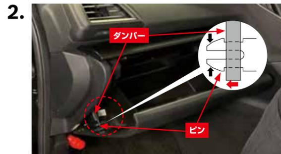
グローブボックス左側のピン先端を両側から押し、ダンパーをピンから引き抜きます。
