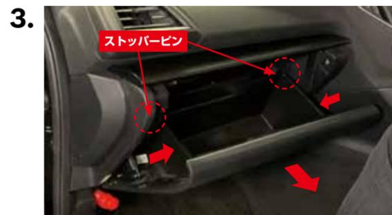
開いたグローブボックス両側を矢印方向に押し込みながら、手前に引いてストッパーピン（左右2箇所）を外します。
