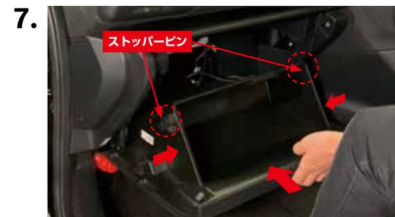
グローブボックス両側を矢印方向に押し込んでストッパーピン（左右2箇所）を押し込むように矢印の方向にグローブボックスを押し閉じます。
