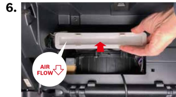
「AIR FLOW」マークが図のようになっていることを確認し、新しいボッシュ エアコンフィルターを矢印の方向へ挿入して取り付けます。
