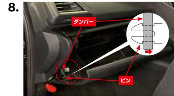
ダンパーの穴部をグローブボックス左側のピン先端に差し込みます。
