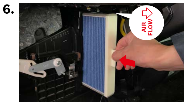
新しいボッシュ エアコンフィルターを矢印の方向から挿入して取り付けます。
