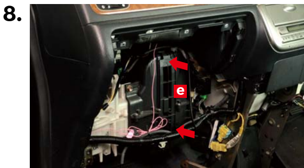
フィルターカバー e を矢印の方向へ押し込んで、上下のロックノブをロックします。
