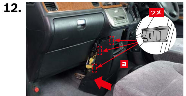
中央パネル a を矢印の方向に押し込み、ツメ(3箇所)を取り付けます。
