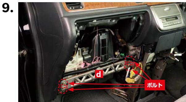
グローブボックスフレーム d を取り付け、ボルト(金属製4箇所)を8mmのレンチで締め付け、グローブボックスフレーム d を固定します。
