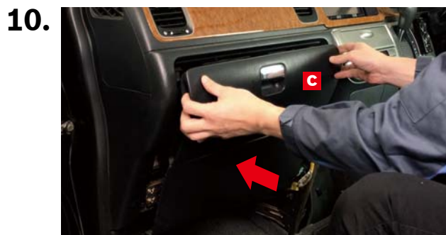
グローブボックス c を矢印の方向に取付けます。
