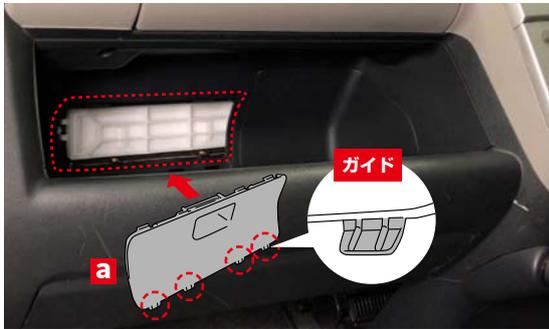
ガイド部 (4ヶ所) を先に車両側へ挿入してカバー (中央) **a** を取り付けます。
