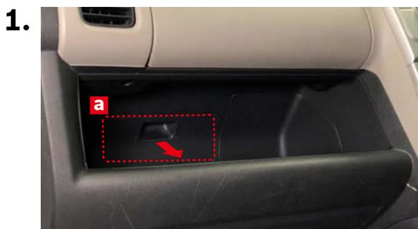
グローブボックス下にあるトレー奥のカバー(中央) **a** を矢印方向に手前に引き出して取り外します。
