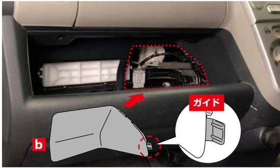
ガイド部を先に車両側へ挿入してカバー (右) **b** を取り付けます。
