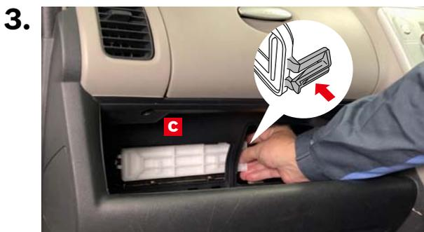
フィルターカバー **c** 右側のツメを矢印の方向に押し手前に引き出し、フィルターカバー **c** をカバー(中央)の開口部から取り外します。
