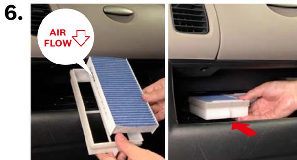
フィルターの向きと「AIR FLOW」マークが図のようになっていることを確認し、新しいポッシュ エアコンフィルターを各フィルターケースに取り付け、フィルターケースを1個ずつ右側から挿入して取り付けます。
