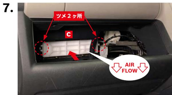
フィルターカバー **c** の「AIR FLOW」マークが図のようにカバー(中央)の開口部から挿入し、左右のツメ部がロックするまで矢印方向に押し込みます。
