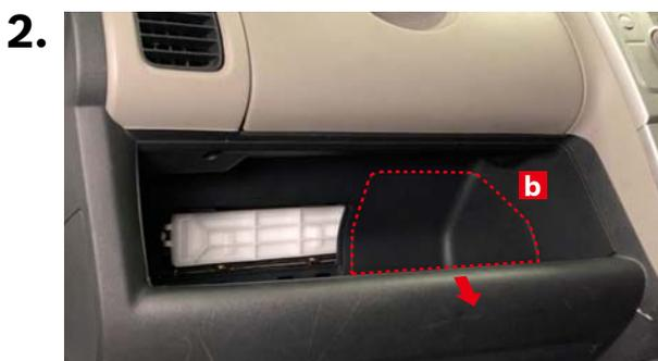
取り外したカバー(中央)の開口部から指を入れ、カバー(右) **b** を裏側から矢印方向に押し取り外します。
