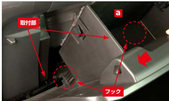
グローブボックスaのフック(左右2箇所)を車両側取り付け部に合わせて矢印方向に押し込みます。
