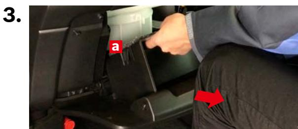
グローブボックスaを少し持ち上げながら矢印方向へ引き、取り外します。
