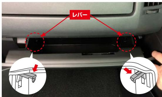
グローブボックス内側の左右レバーを矢印の方向に押し、ロックストッパーを起こします。
