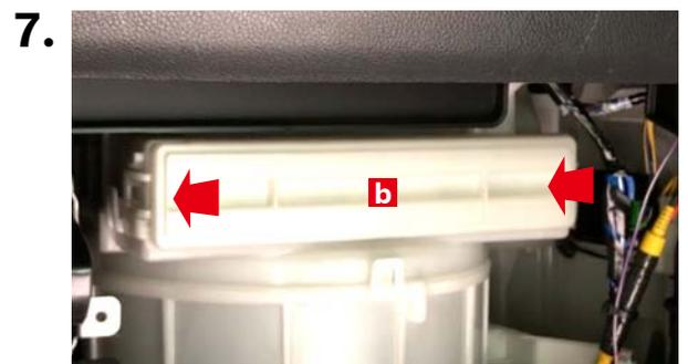
フィルターカバーbを矢印方向へ押し込んで左右のツメ部をロックします。
