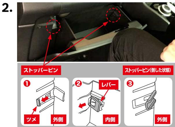
開いたグローブボックス両側のストッパーピン(左右2箇所)を①グローブボックス外側からツメを矢印の方向に押してロックを解除します。②グローブボックス内側のレバーを矢印の方向に引きます。③ストッパーが倒れます。グローブボックスを手前に引き出します。
