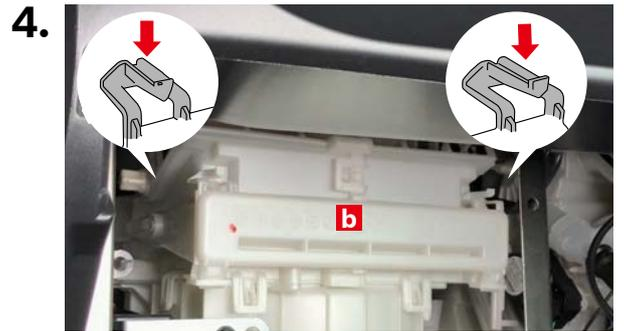
フィルターカバーbのツメを矢印の方向に押してフィルターカバーbを取り外します。
