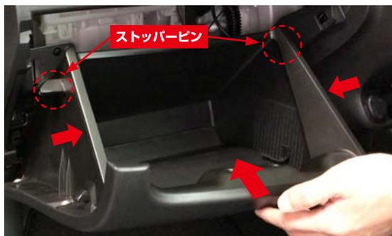
グローブボックス両側を矢印方向に押し、ストッパーピン(左右2箇所)を押し込むように矢印の方向にグローブボックスを押し、閉じます。
