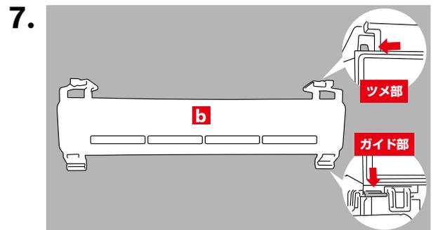
フィルターカバーbのガイド部を先に車両側に矢印方向へ差し込んでから、ツメ部を矢印方向へ押し込んでロックします。
