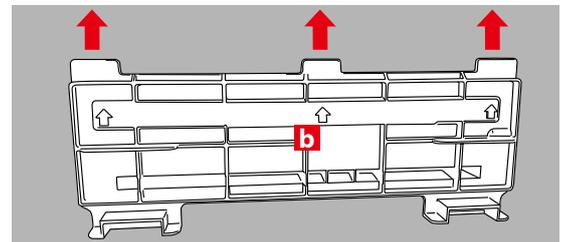
フィルターカバー**b**のガイド部 (3ヶ所)を先に車両側に矢印方向へ差し込んでから、ツメ部 (2ヶ所)を押し込んでロックします。
