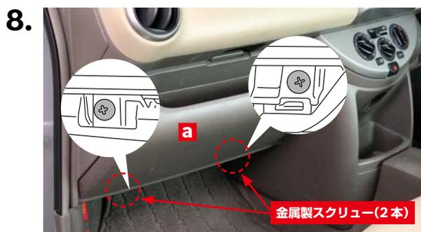
グローブボックス**a**を閉じて、下側の取り付けスクリュー (金属製2本) を+ドライバーで取り付けます。
