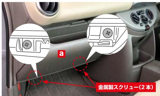
グローブボックス**a**下側の取り付けスクリー（金属製2本）を+ドライバーで取り外します。
