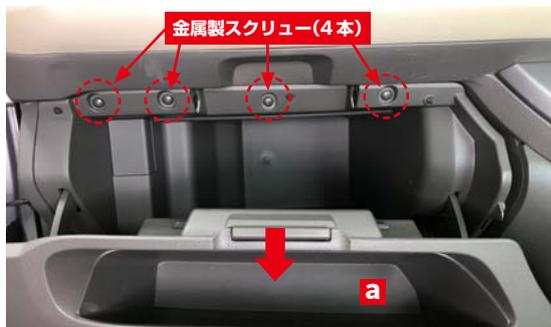
グローブボックス**a**を開き、上側の取り付けスクリー（金属製4本）を+ドライバーで取り外してグローブボックス**a**を矢印方向に引き出して取り外します。
