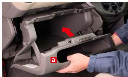
グローブボックス**a**のツメ (5ヶ所) を車両側と合わせて矢印方向にグローブボックス**a**を押し込み、取り付けます。
