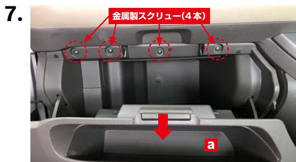
グローブボックス**a**上側の取り付けスクリュー (金属製4本) を+ドライバーで取り付けます。
