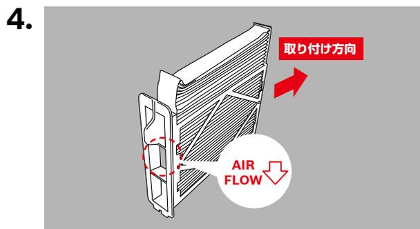
フィルターの向きと「AIR FLOW」マークが図のようになっていることを確認します。
