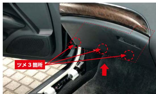
アンダーカバー**c**手前側のツメ(3箇所)を車両側に矢印方向に押し込んでロックします。
