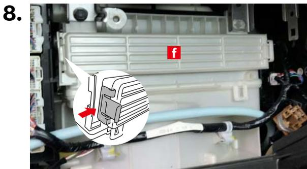
フィルターカバー<sup>f</sup>のツメを矢印の方向に押してフィルターカバー<sup>f</sup>を取り外します。
