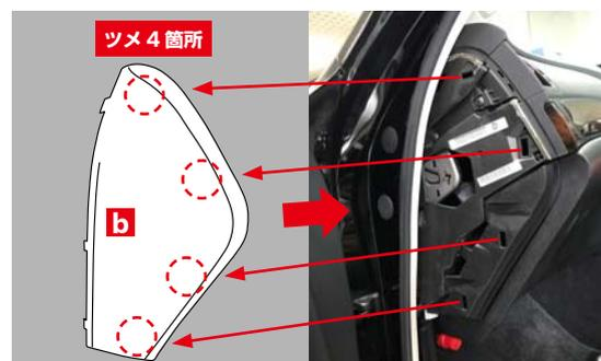
グローブボックス横のサイドカバー**b**のツメ(4箇所)を合わせて取り付けます。
