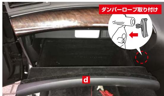
①グローブボックス**d**のヒンジ(3箇所)を矢印方向へ押し、車両側に取り付けます。②ダンパーロープを車両側から引き出し、グローブボックス**d**右側に取り付けます。③グローブボックス**d**を閉じます。
