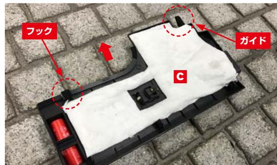
アンダーカバー**c**のガイド(右側)とフック(左側)を車両側の取り付け部に合わせて矢印方向に押し込みます。
