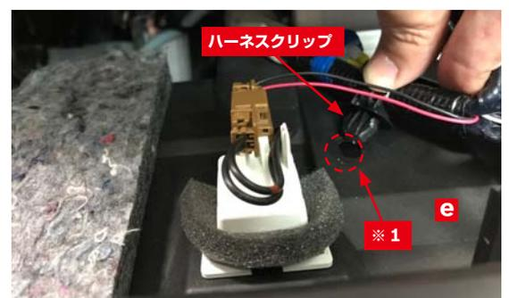
①グローブボックスカバー<sup>e</sup>に各配線コネクタを接続します。②ETC搭載車等でグローブボックスカバー<sup>e</sup>の「※1」部にハーネスクリップが取り付けられている場合は、ハーネスクリップを「※1」の穴に差し込みます。
