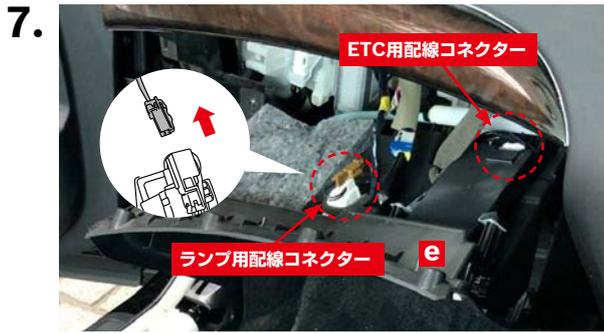
手前に引き出したグローブボックスカバー<sup>e</sup>を各配線コネクタを外して取り外します。
