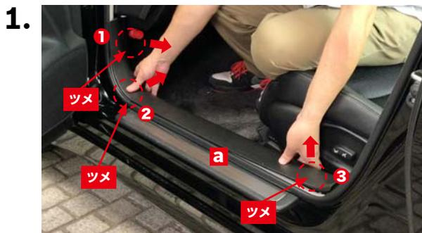
左フロントドア側のステップカバー**a**のツメ(3箇所)を番号順に矢印方向へ引いて取り外します。
