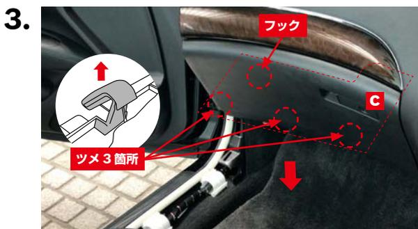
グローブボックス下のアンダーカバー**c**のツメ(3箇所)を矢印方向へ引いて取り外し、奥のフックを外して手前に引き出します。
