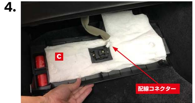
手前に引き出したアンダーカバー**c**の配線コネクターを外して取り外します。
