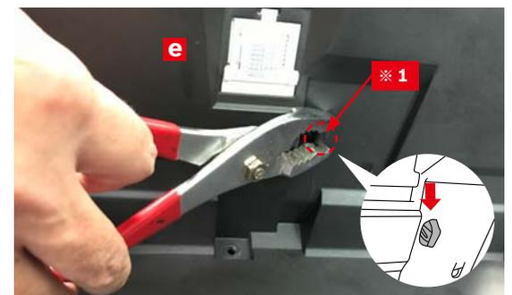
②ETC搭載車等でグローブボックスカバー**e**の「※1」部にハーネスクリップがある場合は、プライヤー等で矢印方向に挟んで外します。
