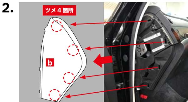
グローブボックス横のサイドカバー**b**のツメ(4箇所)を矢印方向へ引いて取り外します。
