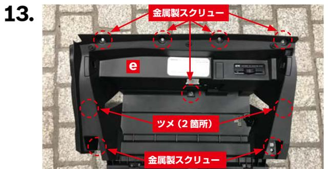
グローブボックスカバー<sup>e</sup>のツメ (2箇所) で車両側と位置決めして取り付け、取り付けスクリュー (金属製7本) を+ドライバーで取り付けます。
