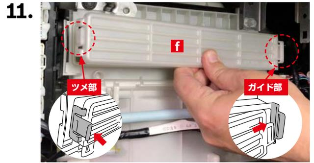
フィルターカバー<sup>f</sup>のガイド部を先に車両側へ差し込んでから、ツメ部を矢印方向へ押し込んでロックします。
