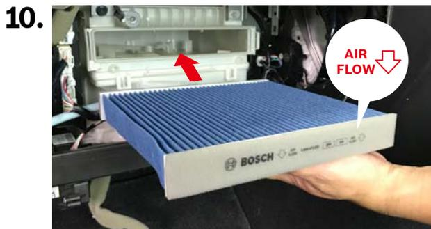
フィルターの向きと「AIR FLOW」マークが図のようになっていることを確認し、新しいボッシュ エアコンフィルターを矢印の方向から挿入して取り付けます。
