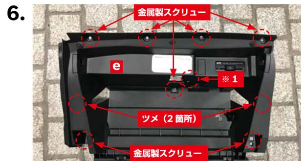
①グローブボックスカバー**e**のツメ(2箇所)と取り付けスクルー(金属製7本)を+ドライバーで取り外して手前に引き出します。
