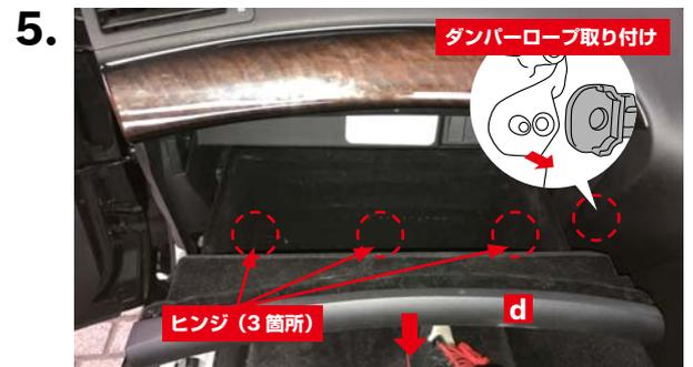
①グローブボックス**d**を開き、ヒンジ(3箇所)を矢印方向へ引いて外します。②グローブボックス**d**を斜めにして右側のダンパーロープの取り付けを外します。③グローブボックス**d**を取り外します。
