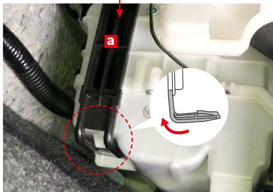
フィルターカバー**a**のツメを矢印の方向に引いてフィルターカバー**a**を取り外します。
