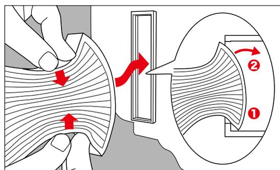
新しいフィルターを両手で図のように変形させます。
