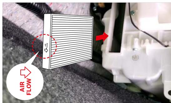
新しいボッシュエアコンフィルターの向きと「AIR FLOW」マークが図のようになっていないことを確認します。
