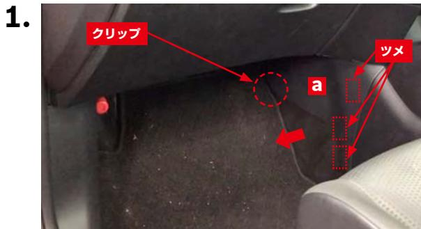
1. 助手席足元のセンターサイドカバー**a**をクリップ (1箇所)、ツメ (3箇所)を折らないように注意し、矢印方向に引っ張って取り外します。
