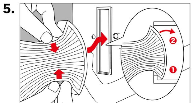
5. 新しいフィルターを両手で図のように変形させます。
