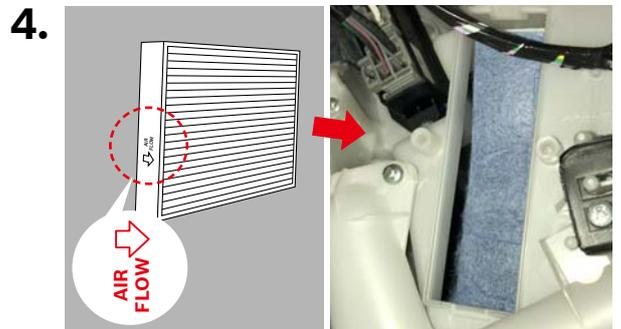
4. 新しいボッシュエアコンフィルターの向きと「AIR FLOW」マークが図のようになっていることを確認します。
