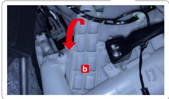
2. フィルターカバー**b**を矢印の方向に引いて、フィルターカバー**b**を取り外します。
