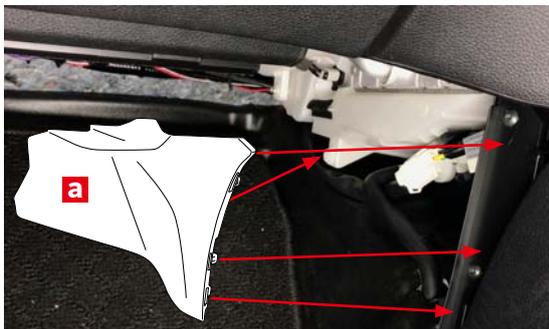
車両側の4ヶ所の穴にセンターサイドカバー**a**のクリップ、ツメを合わせて、センターサイドカバー**a**を取り付けます。
