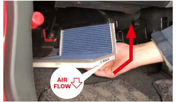
新しいボッシュ エアコンフィルターをフロアパネルに当たらないように折り曲げながら矢印の方向から挿入して取り付けます。
