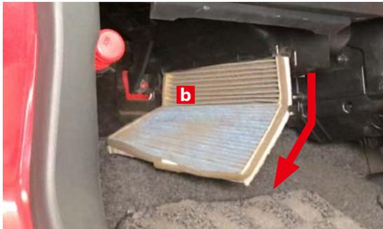
古いエアコンフィルター**b**をフロアパネルに当たらないように折り曲げながら取り外します。
