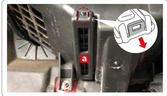
グローブボックス下側のフィルターカバー**a**の前側のツメ部を矢印の方向に引いて外し、フィルターカバー**a**を取り外します。
