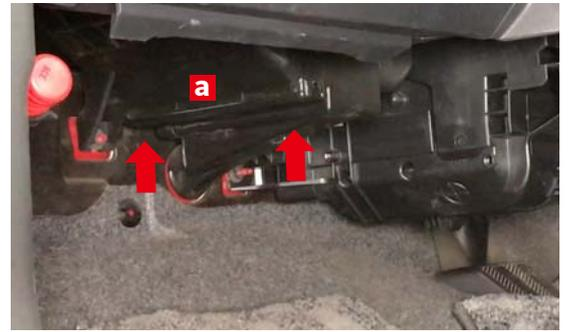
フィルターカバー**a**を矢印方向へ押し込んで左右のツメ部をロックします。
