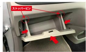
グローブボックス両側を矢印方向に押してストッパー ピン(左右2箇所)を押し込むように矢印の方向にグローブ ボックスを押して閉じます。
