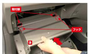
グローブボックス 1のフック (左右2箇所)を車両側取り 付け部に合わせて矢印方向に押し込みます。
