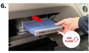
新しいボッシュ エアコンフィルターを矢印の方向から挿入して取り付けます。
