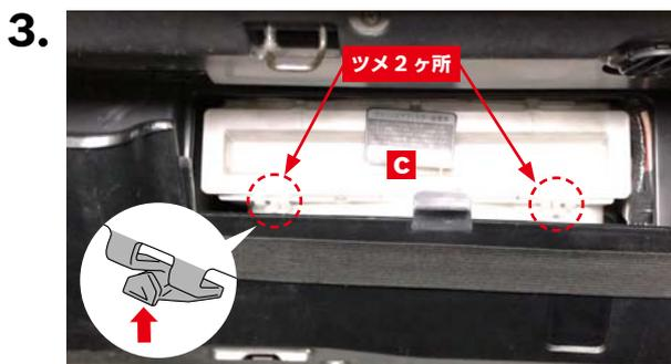
フィルターカバー **c** の2ヶ所のツメを矢印方向に押してフィルターカバー **c** を取り外します。
