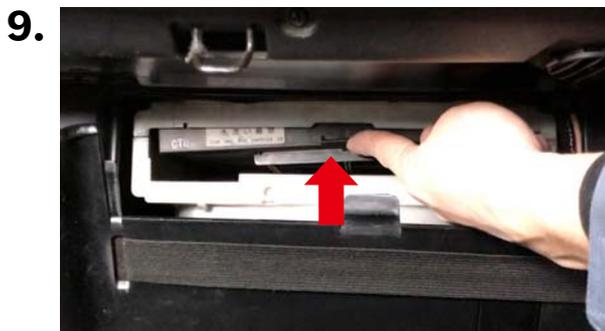
フィルターカバーのつまみを矢印の方向へ上げて取り付けます。
