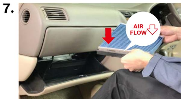
フィルターの向きと「AIR FLOW」マークが図のようになっていることを確認し、新しいポッシュ エアコンフィルターをフィルターケース **d** に取り付けます。
