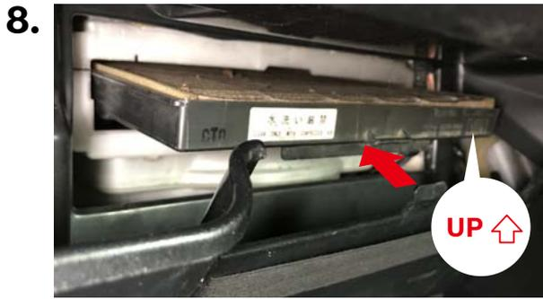
フィルターをセットしたフィルターケース**d**を矢印の方向から挿入して取り付けます。
