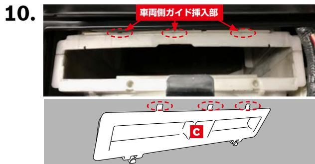
フィルターカバー**c**のガイド部 (3ヶ所)を先に車両側に差し込みます。
