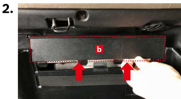
グローブボックス内のトレー **b** を矢印方向に持ち上げて取り外します。
