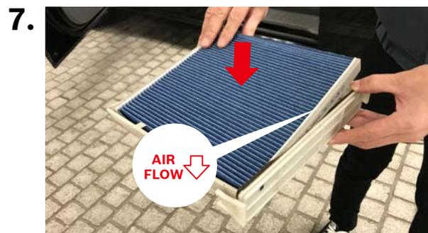
フィルターの向きと「AIR FLOW」マークが図のようになっていることを確認し、新しいポッシュ エアコンフィルターをフィルターケースに取り付けます。
