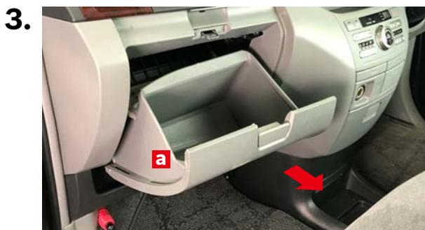
グローブボックス **a** を少し持ち上げながら矢印方向へ引き、取り外します。
