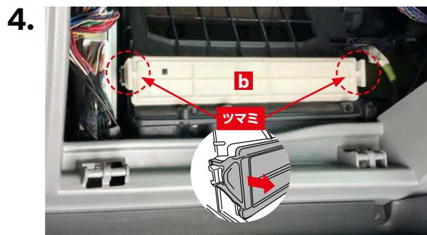
フィルターカバー **b** の左右のツマミを手前に引いてフィルターカバー **b** を取り外します。
