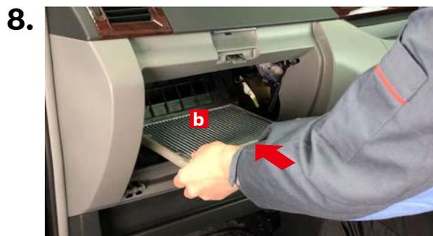
フィルターをセットしたフィルターケース**b**を矢印の方向から挿入して取り付けます。
