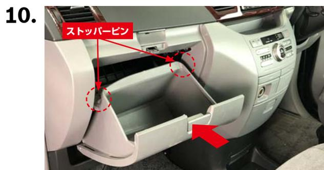
グローブボックス両側のストッパーピン（左右2箇所）を押し込むように矢印の方向にグローブボックスを押しつけて閉じます。
