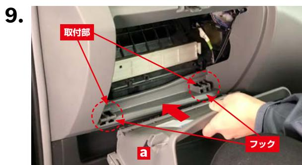
グローブボックス**a**のフック（左右2箇所）を車両側取り付け部に合わせて矢印方向に押し込みます。
