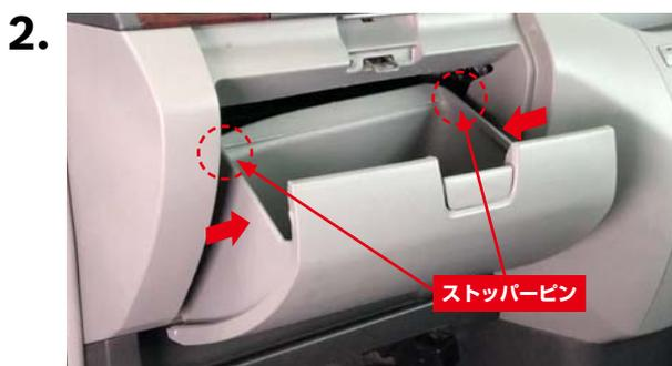
開いたグローブボックス両側を矢印方向に押してストッパーピン（左右2箇所）を内側に押し込んでグローブボックスを手前に引き出します。
