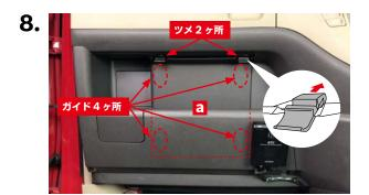
グローブボックスカバー(右) のガイド(4ヶ所)を合わせて取り付け、上側のツメ(2ヶ所)をロックします。
