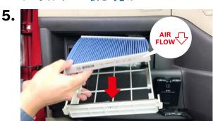
フィルターの向きと「AIR FLOW↓」マークが図のようになっていることを確認し、新しいボッシュ エアコンフィルターをフィルターケースに取り付けます。
