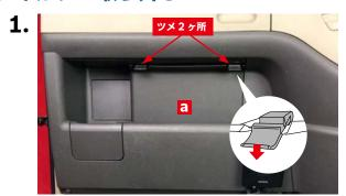
グローブボックスカバー (右) 1を2ヶ所のツメを矢印の方向に押し下げて取り外します。
