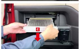
フィルターケース cを左右のツマミを持って手前に引き出して取り外します。
