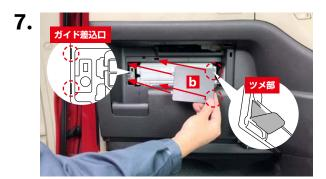
グローブボックスカバー(左) でを先に左側のガイド(2ヶ所) から挿入し、右側のツメを押し込んでロックします。
