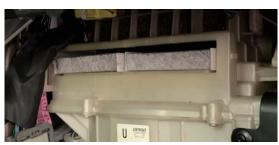
フィルターの向きと「AIR FLOW⊕」マークが図のようになっていることを確認し、2分割された新しいボッシュエアコンフィルターを矢印の方向から挿入して取り付けます。
