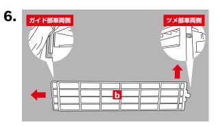
フィルターカバー のガイド部を先に車両側に矢印方向へ差し込んでから、ツメ部を矢印方向へ押し込んでロックします。
