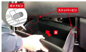
グローブボックスaを左側から車両側に図のような角度で 左側のガイドピン穴にガイドピンを挿入し、ストッパーピン が車両側に当たらないようグローブボックスaを取り付け ます。
