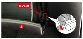
開いたグローブボックス<a>1</a>右側のヒンジを矢印方向に持ち上げながら外し、グローブボックス<a>1</a>を取り外します。
