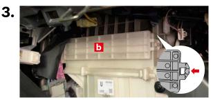
フィルターカバー右側のものツメを矢印の方向に押してフィルターカバーもを取り外します。
