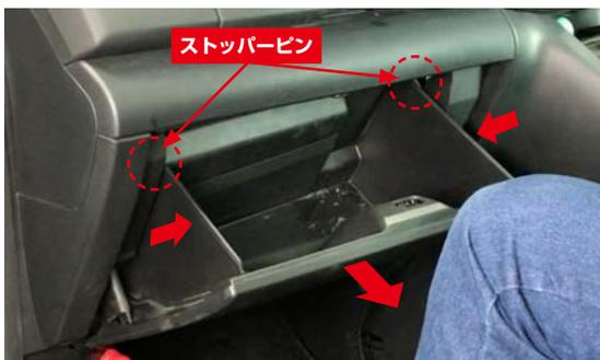
開いたグローブボックス両側を矢印方向に押し込みながら、手前に引いてストッパーを外します。
