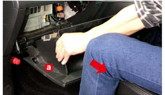
グローブボックスaを少し持ち上げながら矢印方向へ引き、取り外します。
