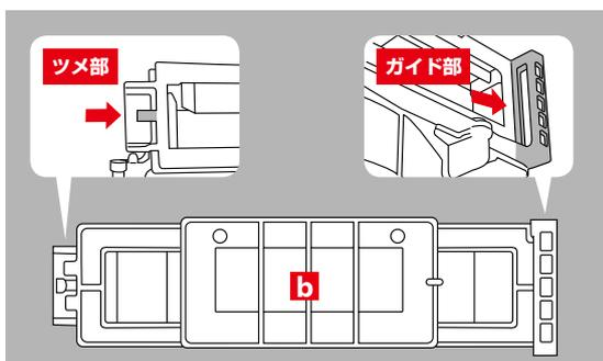
フィルターカバー**b**のガイド部を先に車両側に矢印方向へ差し込んでから、ツメ部を矢印方向へ押し込んでロックします。
