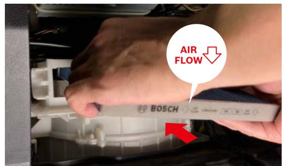
新しいボッシュ エアコンフィルターを矢印の方向から挿入して取り付けます。
