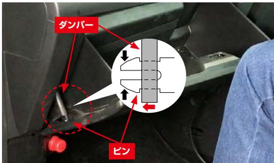
グローブボックス左側のピン先端を両側から押し、ダンパーをピンから引き抜きます。
