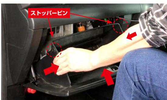
グローブボックス両側を矢印方向に押ししてストッパーピン（左右2箇所）を押し込むように矢印の方向にグローブボックスを押し閉じます。
