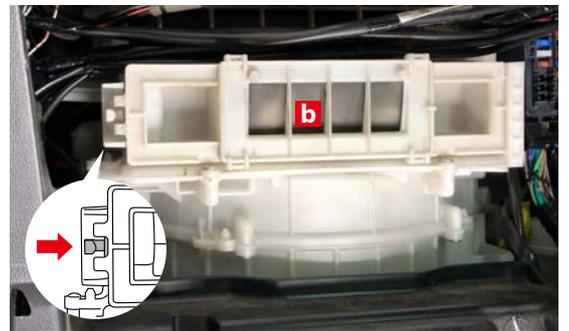
フィルターカバーbのツメを矢印の方向に押し、フィルターカバーbを取り外します。
