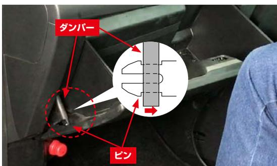
ダンパーの穴部をグローブボックス左側のピン先端に差し込みます。
