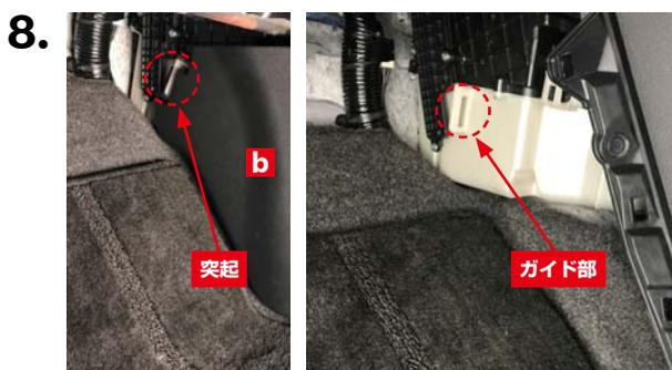
カバー**b**の突起部を車両側のガイド部の穴に挿入し、3箇所のカツメを合わせて取り付けます。
