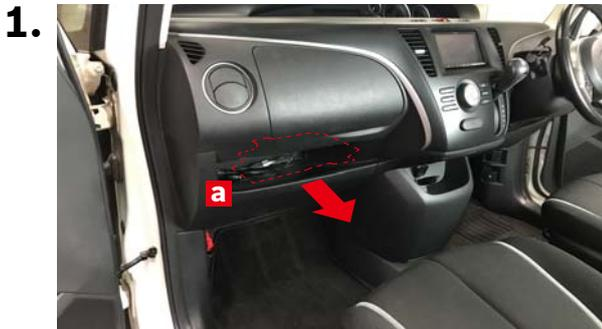
グローブボックス下のアンダーカバー**a**を取り外します。
