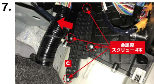
助手席足元右奥のフィルターカバー**c**を取り付けスクリュー（金属製4本）で柄の短い+ドライバーを使用し締め付けます。
