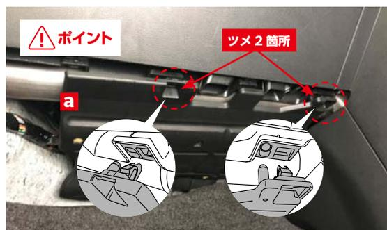
②アンダーカバー**a**手前側の2箇所のツメとピン挿入位置を合わせて取り付けます。
