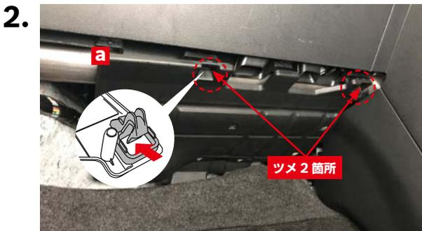
2箇所のツメを矢印の方向に押しアンダーカバー**a**のロックを解除し取り外します。
