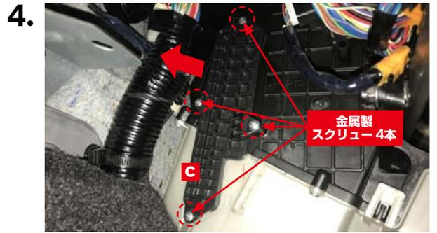
助手席足元右奥のフィルターカバー**c**の取り付けスクリュー(金属製4本)を柄の短い+ドライバーで取り外し、フィルターカバー**c**を矢印方向に外します。
