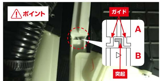
③フィルターAを挿入するときは、フィルターB上部の突起がフィルターA下部のガイドに挟まれるように挿入します。
