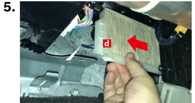
古いエアコンフィルター**d**を矢印の方向へスライドさせて取り外します。
