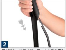
アダプターにワイパーアーム先端を下か「カチッ」となったら取付完了です。 ら差し込みワイパーアーム方向へスライ ドさせます。
