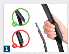
アダプターを持ち上げブレード本体との 隙間を確保します。
