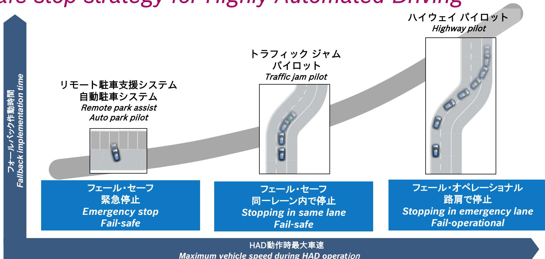
故障が発生しても、安全な所に移動するまでステアリングアシスト機能を継続させることが必要
