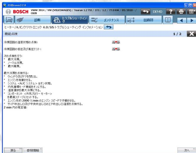
2. 「冷媒回路の低圧及び高圧テスト」を選択します
