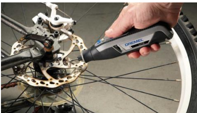
汚れやさび落とし、磨き作業
