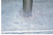
〈作業例〉 ※ブロックへの使用は、チップの摩耗が速くなります。
